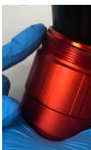
ubrifique a rosca e feche o depósito
