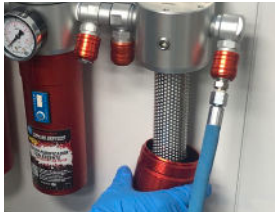
Dévisser le réservoir du filtre
