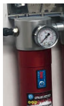
ubrifique a rosca e feche o depósito
