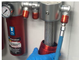
Desmonte o depósito
