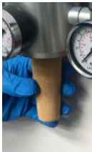
Setzen Sie den Ersatzfilter ein
