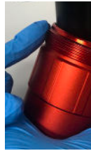
Graissez le filetage et fermez le réservoir
