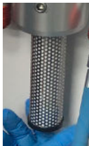
Setzen Sie den Ersatzfilter ein
