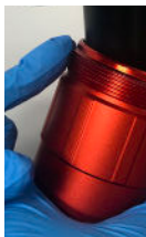
Graissez le filetage et fermez le réservoir
